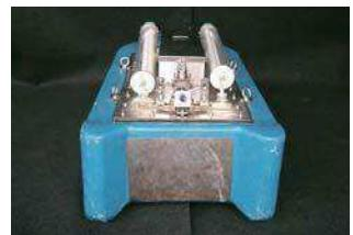
写真-2 船型調査ロボット(正面写真)
