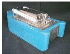
写真-1 船型調査ロボット(側面写真)
